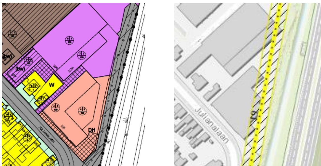
Afbeelding 2.4 Overlap bebouwing en leidingtracé voor de bestemming en Detailhandelsdoeleinden en Bedrijfsdoeleinden (bron: bestemmingsplan Raamsdonksveer Zuid, Kadastrale Perceelnummers RDK02K 4090 en RDK02K 4091)
