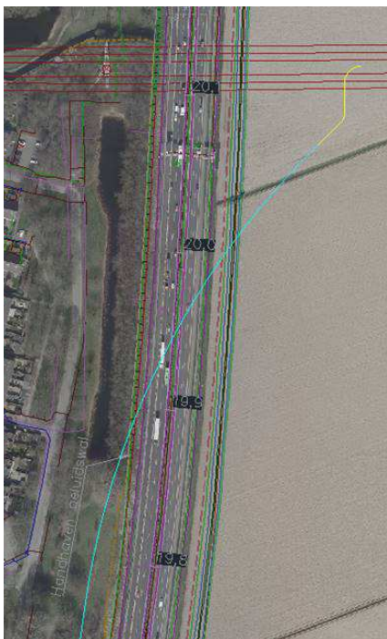
Indicatieve weergave van de mogelijke schuine boring onder de A27 door (deze boring dient in de volgende fase verder te worden onderzocht om de exacte ligging te kunnen bepalen)
